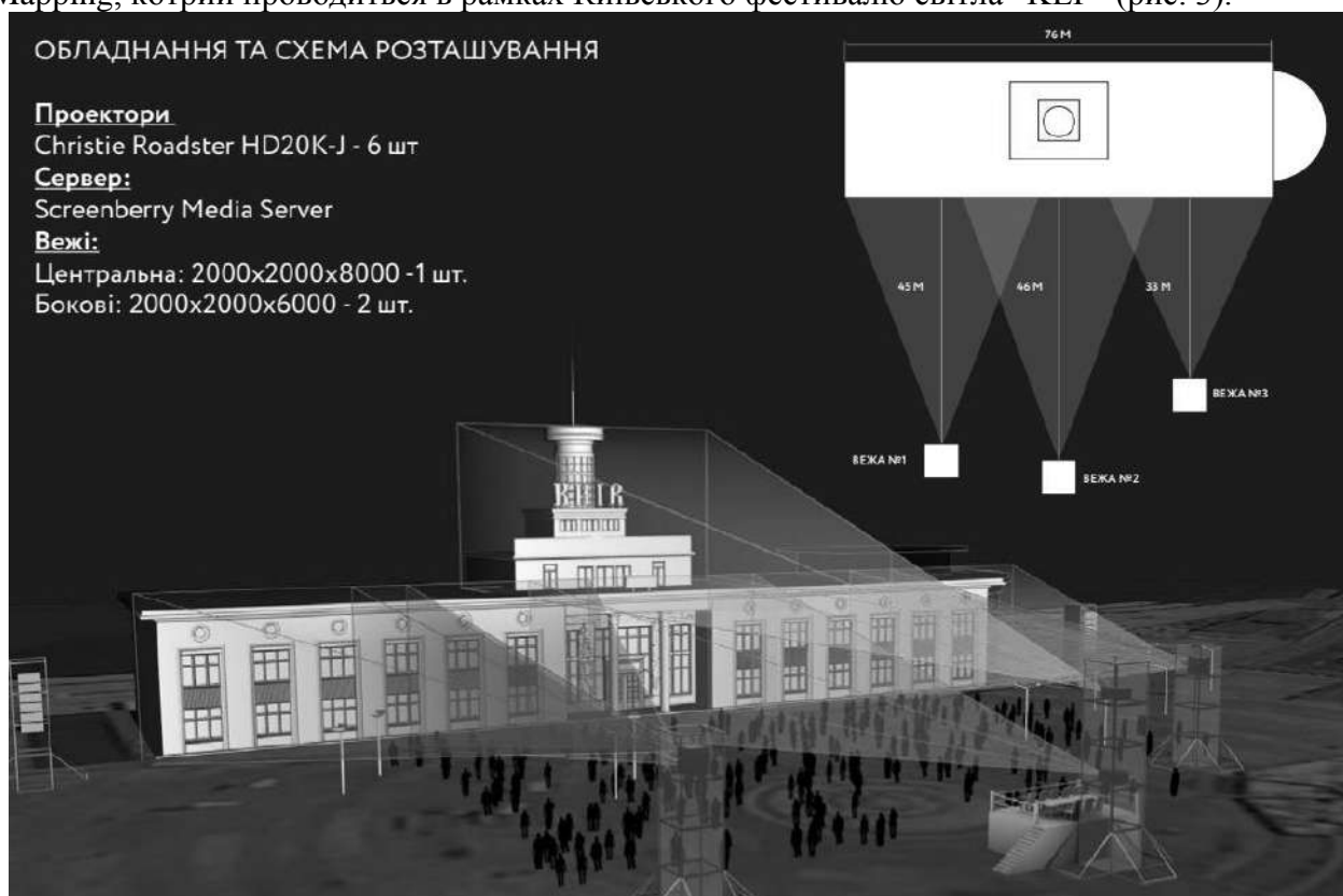
Рисунок 3. Схема розташування проєкторів для освітлення будівлі Київського річкового вокзалу Figure 3. The layout of the projectors for lighting the building of the Kiev River Station
